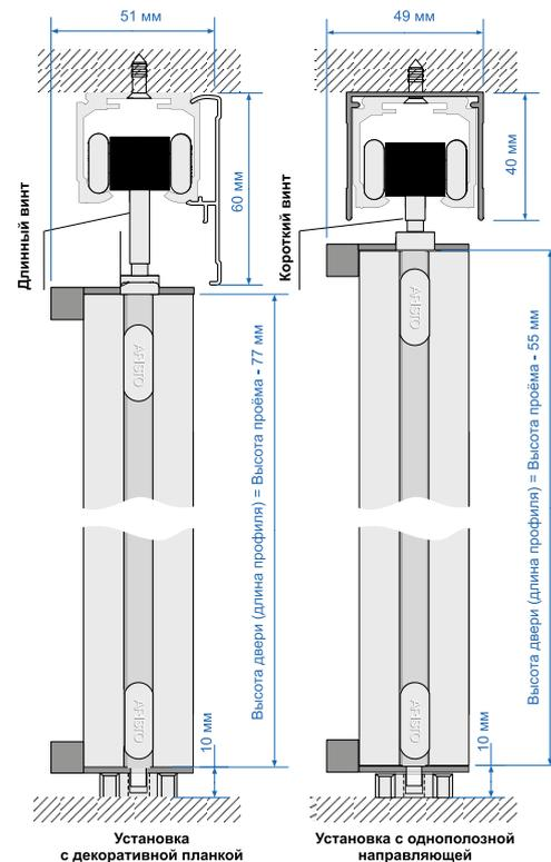
Регулировка по высоте - максимум 3 мм
