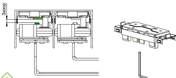
Перед началом монтажа на NOVA, отсоедините от доводчиков монтажные вилки
