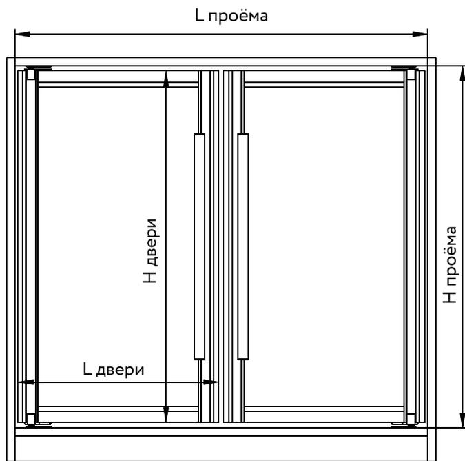
$$L \text{ двери} = L \text{ проёма} - 10 \text{ мм}$$
