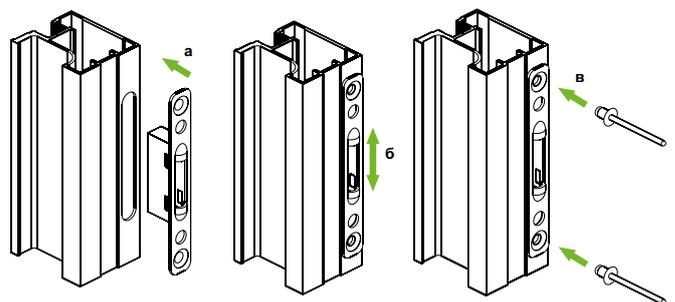
**1** Выполните разметку на профиле А и Б, просверлите отверстия для замка.
