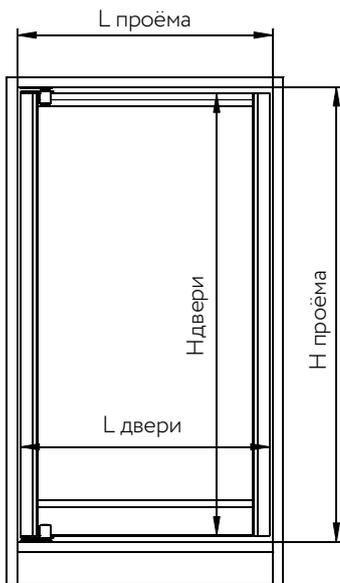
$$L \text{ двери} = L \text{ прoёма} - 10 \text{ мм}$$
