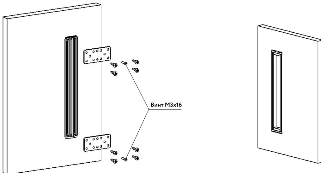
7 Сборка врезной ручки из профиля ручки врезной (NB0746). Врезная ручка собирается из профиля врезной ручки и торцевых заглушек (NA0036). Винты для фиксации торцевых заглушек к профилю М3х6мм.
