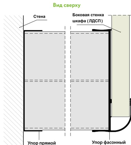
Рекомендация: упоры фиксируются к боковым панелям шкафа с помощью двухсторонней клейкой ленты.
