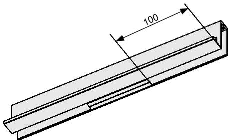
❷ Схема сверления отверстий в вертикальном профиле.
