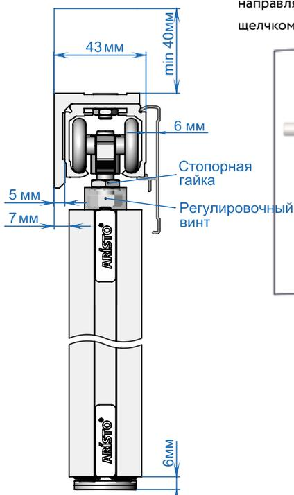
12 Установите дверь. Еще раз отрегулируйте высоту и горизонт. Дверь в нужном положении фиксируется стопорной гайкой на верхнем ролике.
