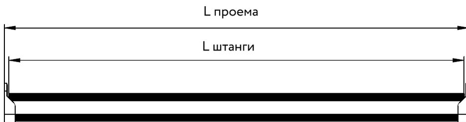
$$L \text{ штанги} = L \text{ проёма} - 10 \text{ мм}$$
