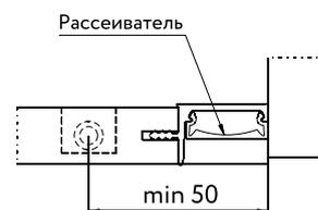
Система GOLA. Установка профиля для верхней базы, под подсветку, для плиты 18 мм
