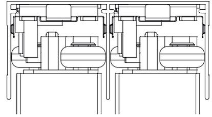
1 Закрепите доводчик саморезами, с одной стороны подложив шайбу. Установите доводчик в упор к ребру верхнего горизонтального профиля.
