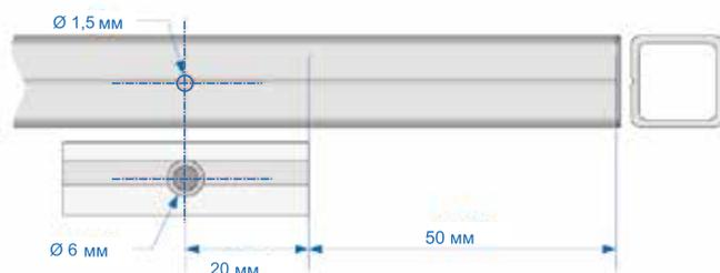
5 Просверлите при помощи дрели или шуруповерта сверлом диаметром 1,5 мм монтажное отверстие в ручке-рейлинге.
