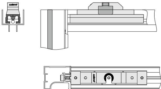
**6** Разметьте и просверлите отверстия в верхней направляющей, как показано на рисунках (расстояние между центрами крепежных отверстий не должно превышать 500 мм):
