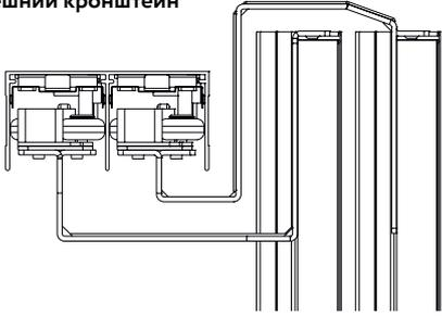
1 Установите дополнительный кронштейн на дверь, как показано на рисунке. При установке край доводчика должен совпадать с краем кронштейна.
