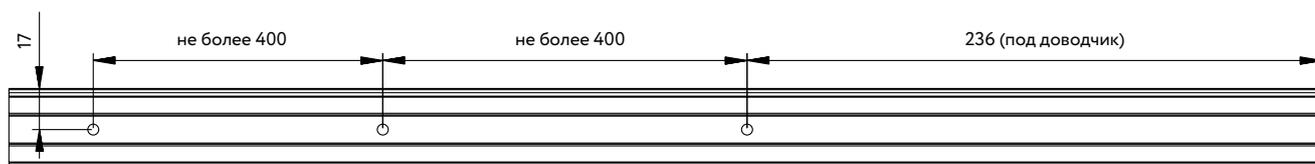
**2** Зафиксируйте доводчик к верхней рамке через планку саморезом, входящим в комплект. Дополнительно зафиксируйте планку к верхней рамке саморезами 3,9 x 9,5 мм.
