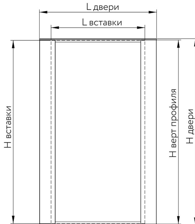
$$\begin{aligned} H \text{ верт профиля} &= H \text{ двери} - 10 \text{ мм} \\ H \text{ вставки} &= H \text{ двери} - 13 \text{ мм} \\ L \text{ вставки} &= L \text{ двери} - 89 \text{ мм} \end{aligned}$$
