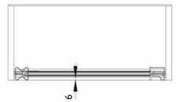
**4** Фиксируем нижнюю закладную шестигранным ключом
