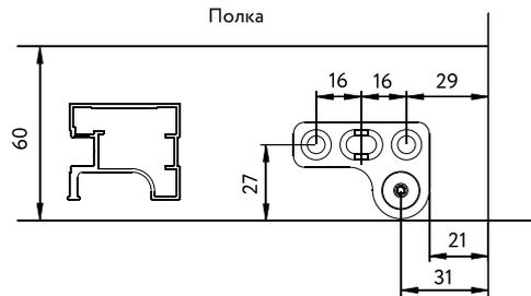
«слепая зона» для установки выдвижных элементов 80 мм
