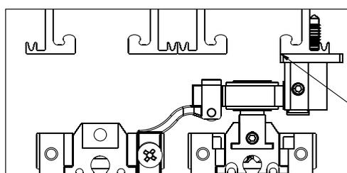
Основание фиксатора на одном уровне с внутренней стенкой трека
