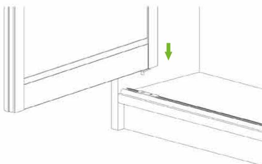
**9** Как ограничитель двери в системе используются магнитные защелки (возвратные, невозвратные). Устанавливаются на боковую, верхнюю или нижнюю панель шкафа.
