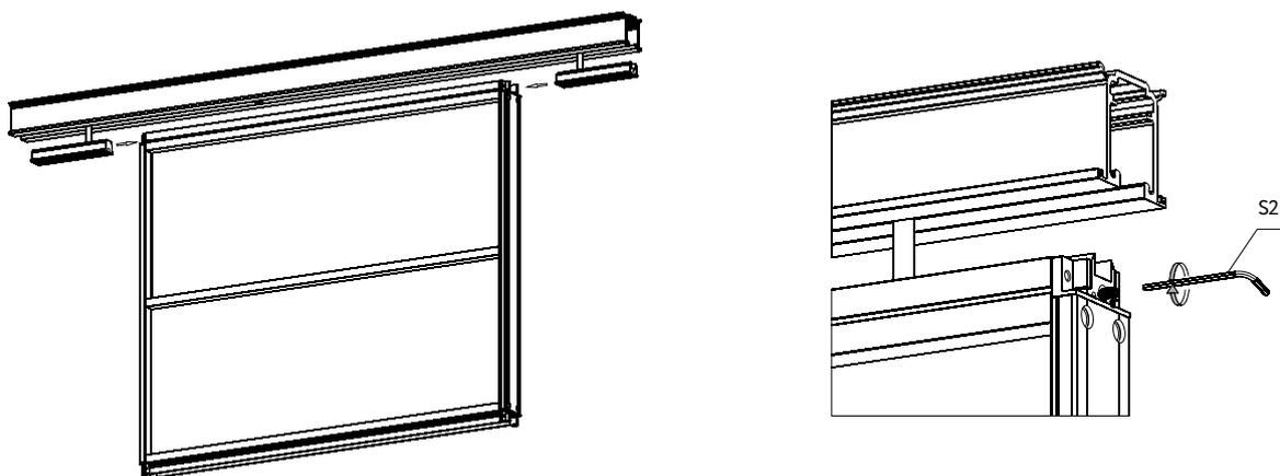
6 Отрегулируйте дверь по высоте. Разметьте и прикрутите нижний ролик к полу. Положение ролика показано в вариантах установки конструкций.
