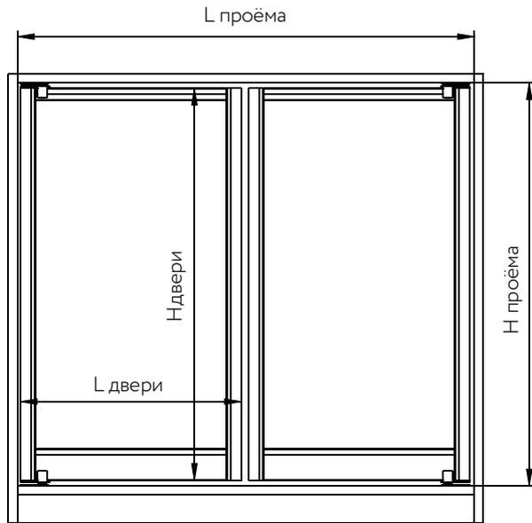
$$L \text{ двери} = (L \text{ прoёма} - 20 \text{ мм}) / 2$$
