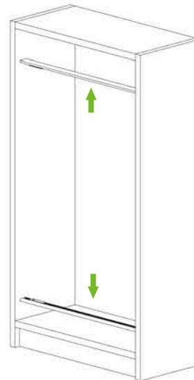
Отступ направляющей в зависимости от конфигурации профиля.
