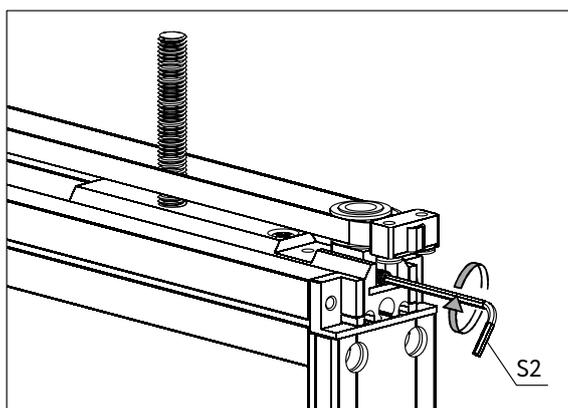
6 Заведите фурнитуру в направляющие и зафиксируйте их к потолку. Показана установка треков для дверей связанных механизмом.
