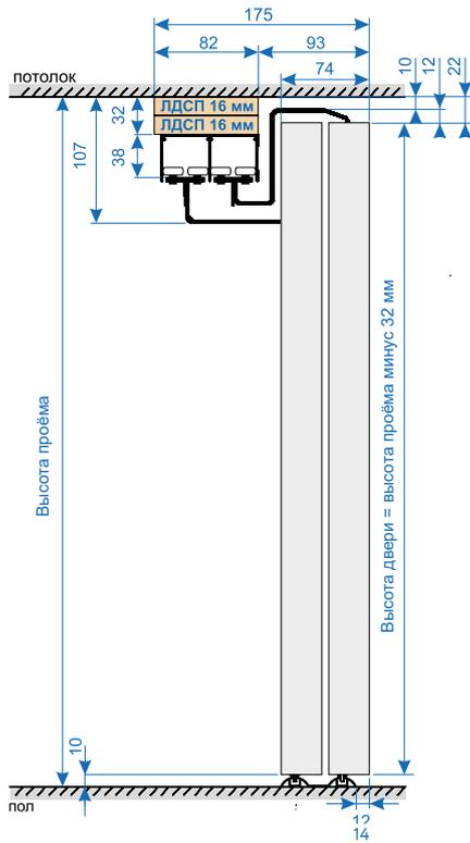
**Скрытая установка направляющей верхней в шкаф**
