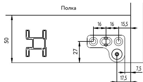
«слепая зона» для установки выдвижных элементов 60 мм
