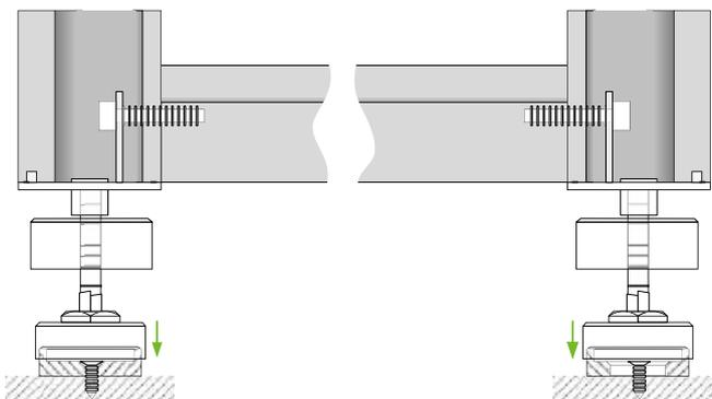
**8** Выравниваем перегородку вертикально с помощью строительного уровня.
