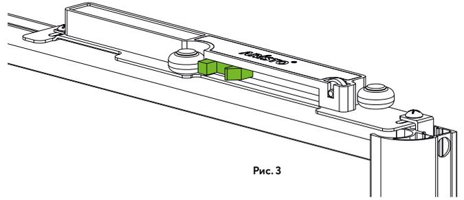
4 Устанавливаем ответную планку доводчика в верхнюю направляющую до упора вверх, размещая в любом месте со стороны, где будет стоять дверь (рис. 4). Вставляем дверь в направляющие в стороне от ответной планки. Руками доводим дверь до края шкафа (ответная планка сама встанет в нужное место). Отводим дверь обратно, при этом доводчик взведется. Фиксируем ответную планку саморезами.
