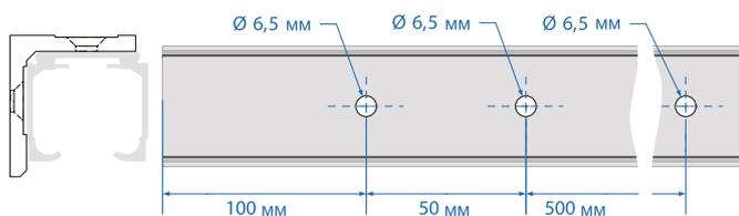
**7** Отметьте и просверлите крепежные отверстия для установки направляющей в стене или в потолке. Если крепление происходит к стене, то сначала установите подвесы, как показано на рисунке выше.
