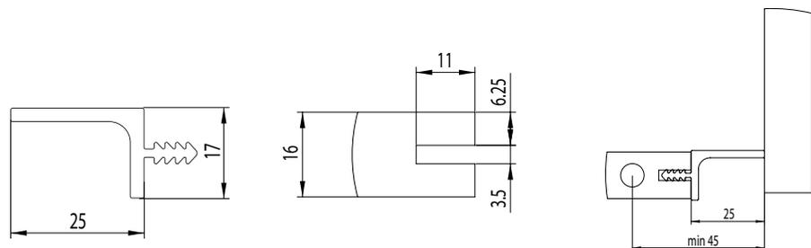
Система GOLA. Установка в колонну профиль L
