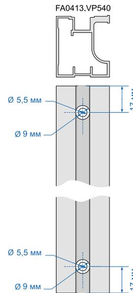
4 Расчет длины рамок:  $L(\text{рамок}) = L(\text{двери}) - 78 \text{ мм}$ . Нижняя, верхняя и средняя рамки имеют одинаковую длину.
